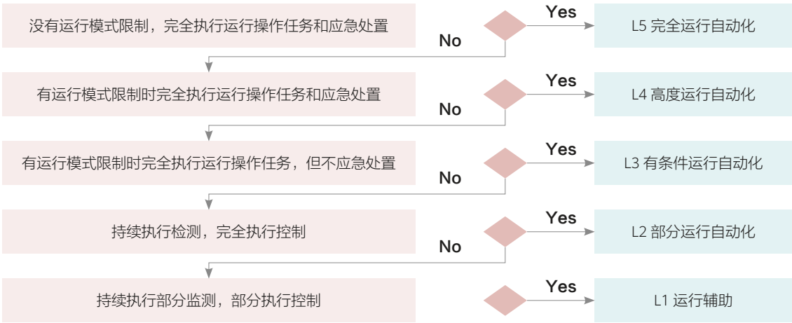
图 2-1 数据中心自动化发展的五个阶段
